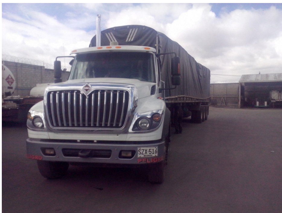
Foto 2. Vehículo de la flota de Oleotankes, Marca International, Línea Workstar 7600, motor ISM Cummis.
